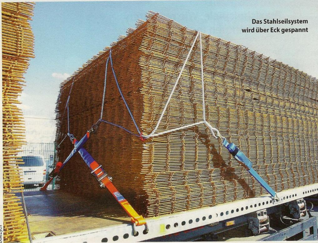
Das Stahlseilsystem wird über Eck gespannt
